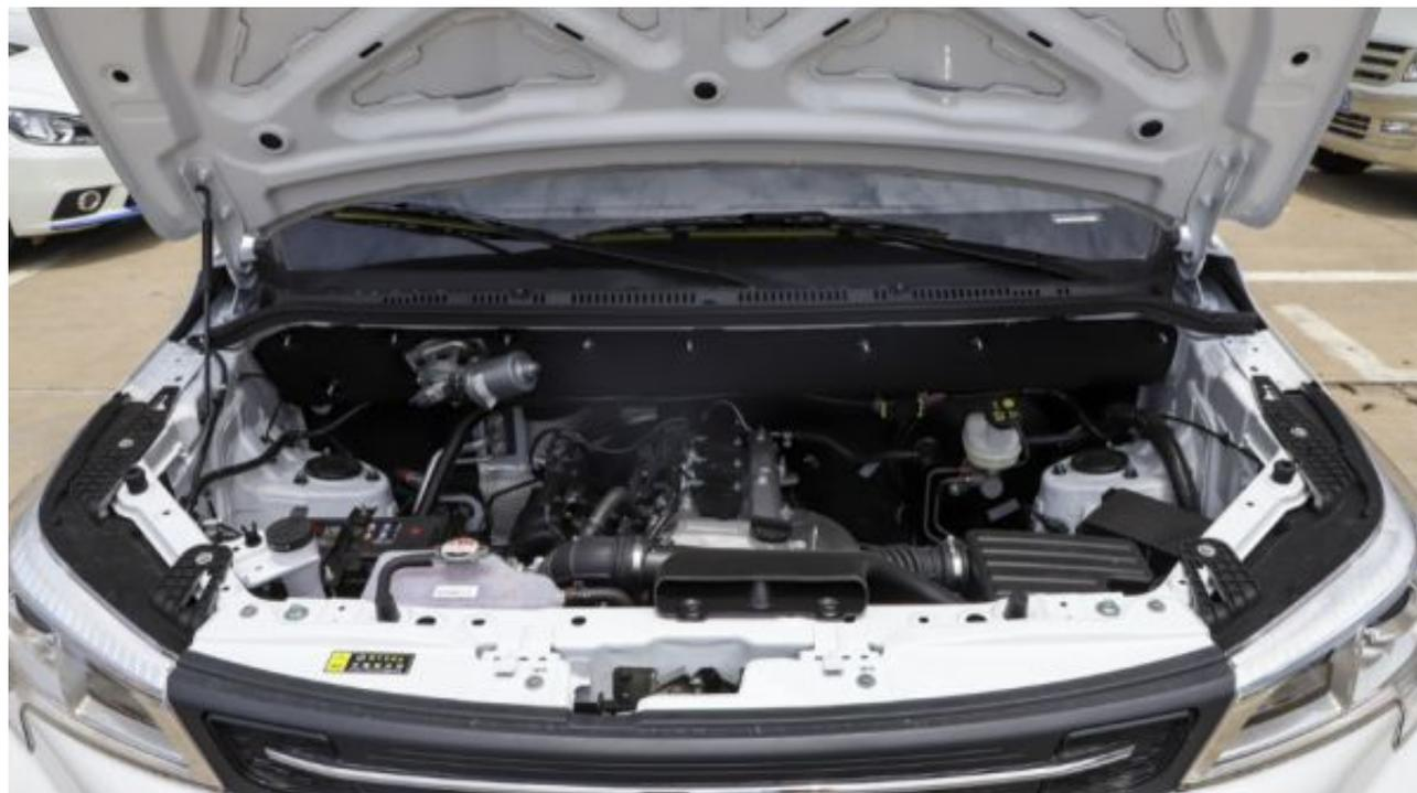
风光380搭载了一台1.5L自然吸气发动机，匹配了5MT变速箱，其发动机最大功率为82千瓦，最大扭矩为147牛·米。这个动力水准还是挺强劲的，拉一些大件的货物也不在话下，平时驾驶也不会出现疲软的情况，完全能够满足日常载人拉货的需求。
