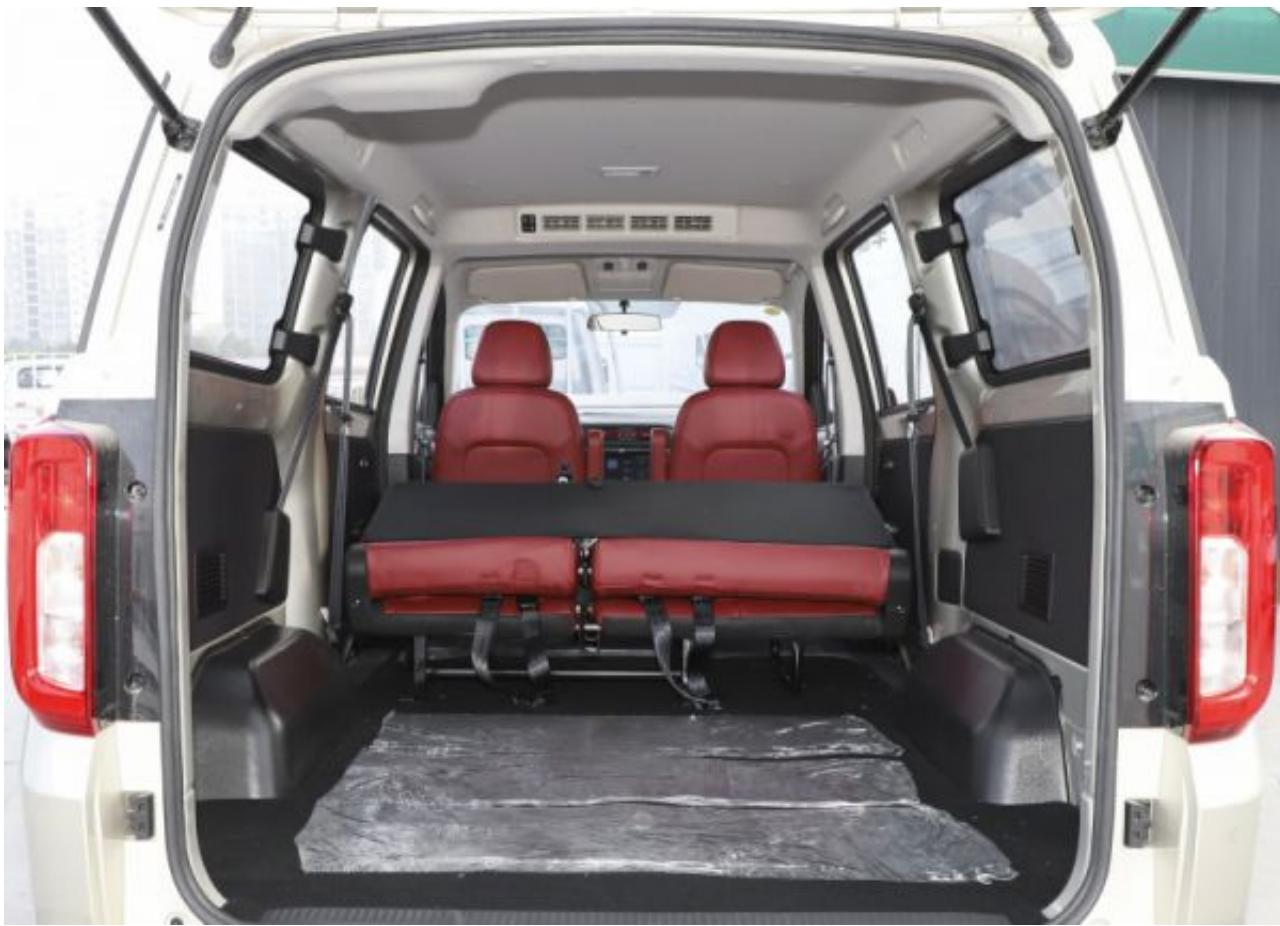
空间方面，风光380的长宽高分别为4610/1750/1860mm，轴距为2850mm。提供两座，五座，七座和八座等多种座椅布局，并且后排座椅能够放倒和拆卸，使得风光380拥有了5m<sup>3</sup>的内部空间，满载8人的情况下还能轻松装下10个20寸拉杆箱，这灵活性和实用性绝对是风光380的优势所在。
