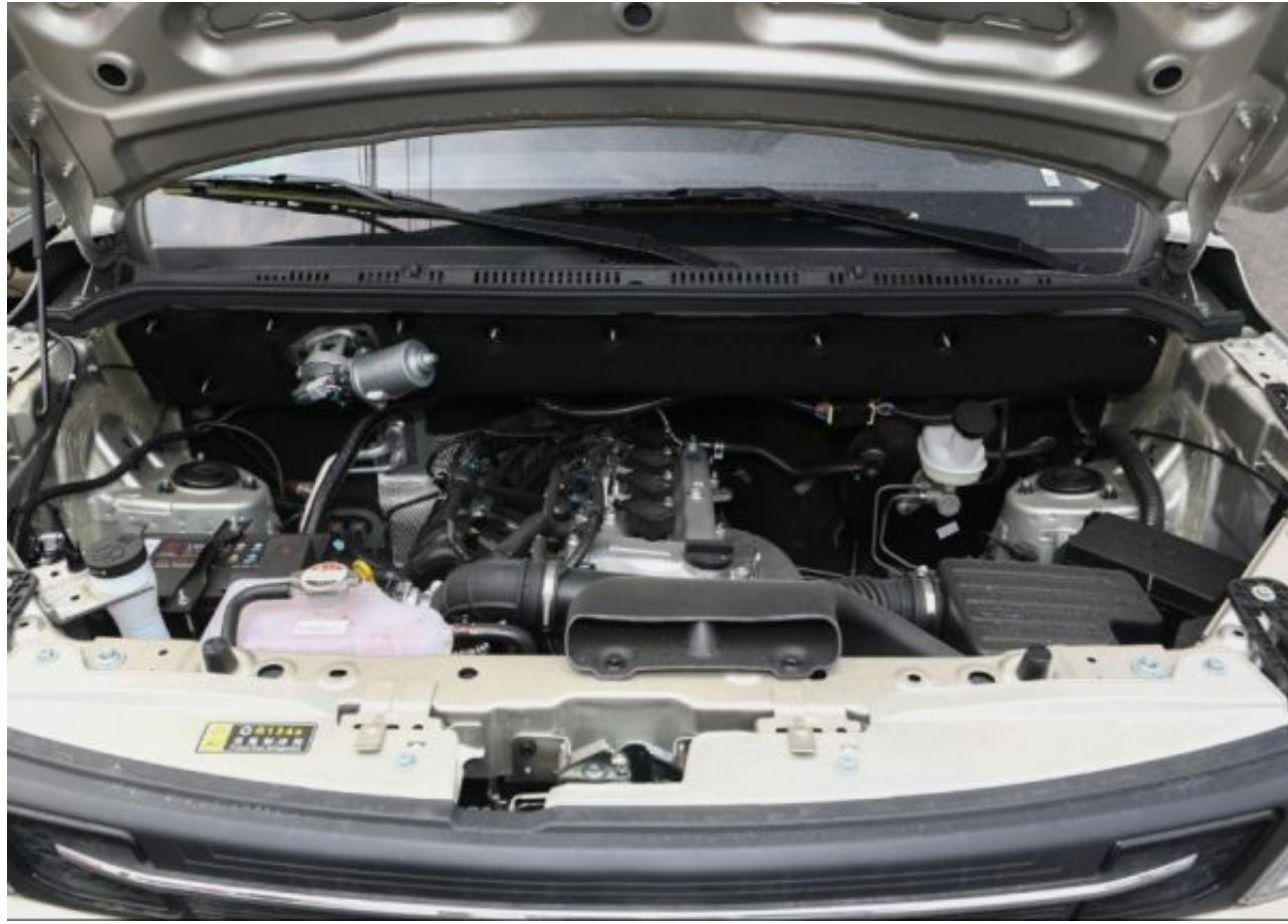
风光380的这台1.5L发动机最大功率112马力，峰值扭矩147牛·米，在同级车型中算是动力参数最好的，无论是满载爬坡，还是走烂路，整体的驾驶感受还是很轻松的，能够满足用户多拉快跑的用车需求。
