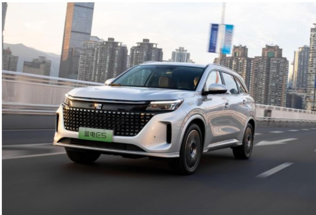
关键是不仅价格亲民，蓝电E5确实有着出色产品表现，成熟可靠的插混系统就是一大亮点。蓝电E5搭载弗迪电混，包括1.5L高效插混专用发动机和DHT300电混系统，这套系统正是弗迪动力针对大中型SUV和轿车打造的电混方案，与当前最为热销的比亚迪宋PLUS DM-i在动力上堪称是同出一脉。这套插混系统特点是以电为主，可实现全工况电驱占比超80%、市区工况电驱占比99%，在蓝电工程师团队的精心调校下，蓝电E5很好地平衡了能耗、保电、NVH、加速等方面的综合需求，发动机最大功率81kW、最大扭矩135N·m，电动机最大功率130kW、最大扭矩300N·m，0-50km/h的加速时间仅为2.91s，足以媲美诸多2.0T动力。
